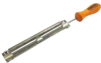
Die Rundfeile wird in ein Führungsblech eingespannt und mit einer Strichmarkierung parallel zur Schiene durch den Hobelzahn geführt. Die Eindringtiefe der Feile regelt das Führungsblech. Mit ein wenig Übung werden perfekte Schärfungen erzielt.
