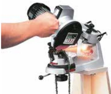
Das Kettenschärfgerät MAXX mit 180 Watt, 2.950 U/min und 145 mm-Schleifscheiben bietet eine praktische und effiziente Lösung für das Professionelle Schärfe von Sägeketten. Insbesondere die automatische Klemmung der Sägekette in der Führungsschiene beim Herabdrücken des Schleifkopfes rationalisiert das Kettenschärfen. Serienmäßig ist eine Scheibenbeleuchtung und 3 Schleifscheiben enthalten.
