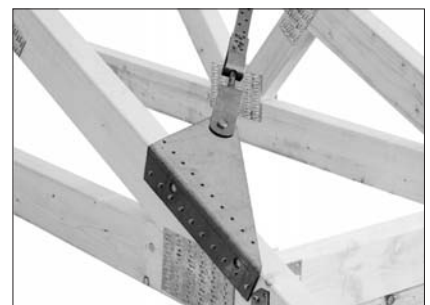
Detail am Traufpunkt: Bandanschluss BNG25 mit Spanngerät BNSP25 seitlich am Sparren mit Nägeln befestigt. Holzbreite: mind. 45 mm, max. 100 mm.
